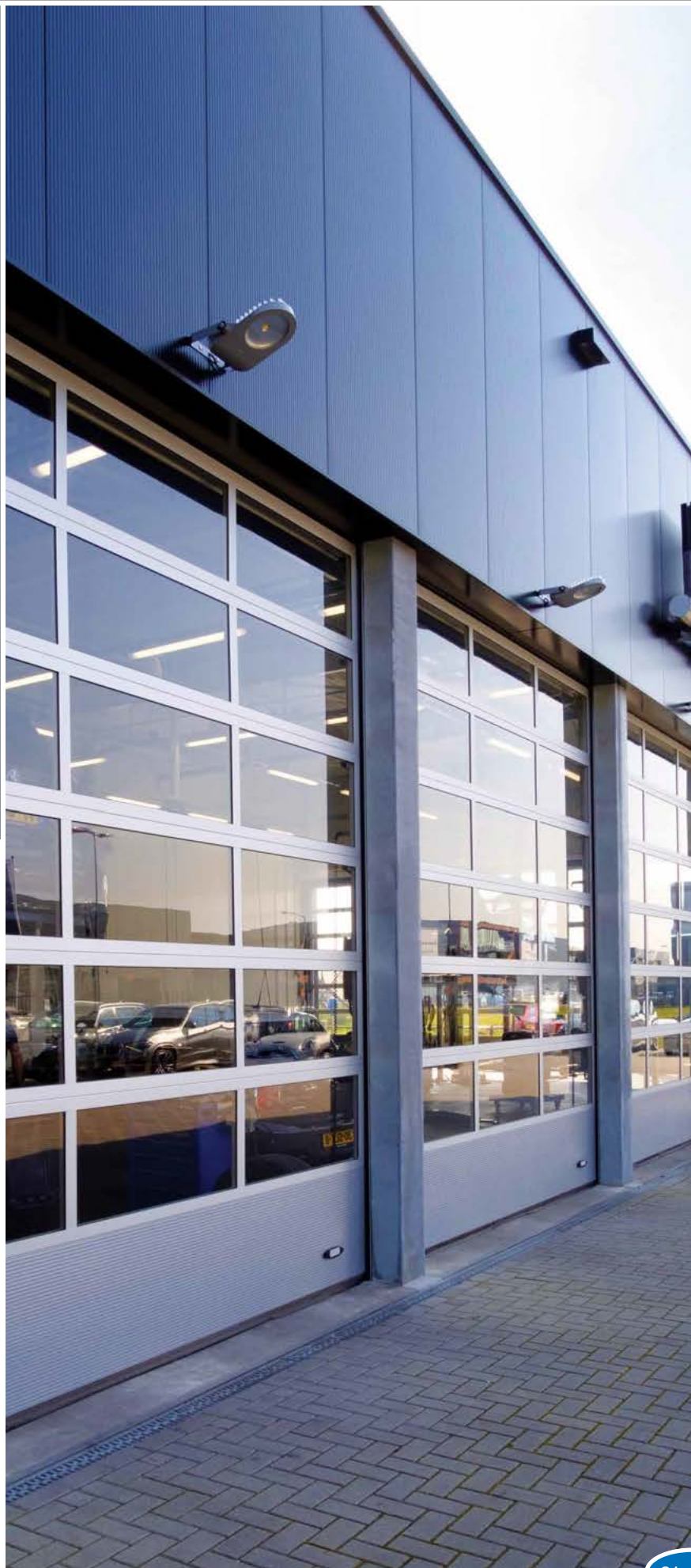
U-Wert NovoLux 60 mm Sektionaltor: 5000x5000 mm: 2,33 W/m 2 K, bei Dreifachverglasung
